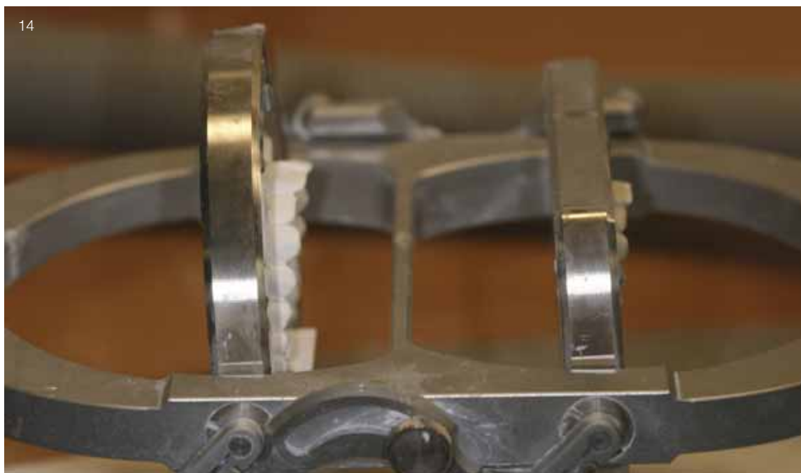
Abb. 14 Das Kunststoffdupli- kat des Wax-ups wurde wie der Kunst- stoff-Steg in einen Fräsrahmen einge- klebt und mit dem Kopierfräser aus Zir- konoxid gefräst. Die Fünf-Achs-Techno- logie erlaubt alle Frei- heitsgrade. So auch das Anstellen und Fräsen der fast hori- zontalen Kanäle für die Verbolzungen
