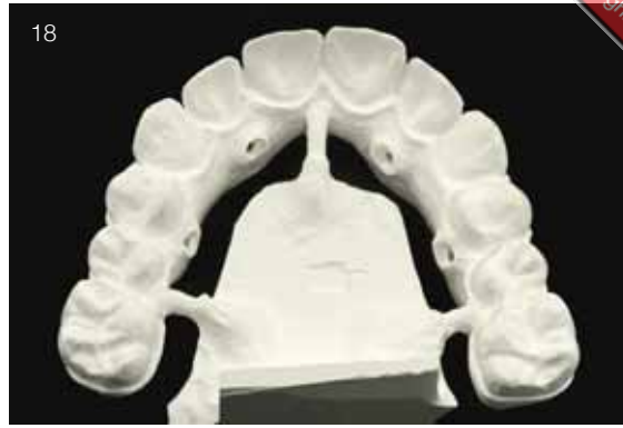
Abb. 17 und 18 Indem wir das Duplikat an den gewünschten Stellen erneut abtasten, gewährleisten wir an dem vorgefrästen Zirkonoxid-Duplikat einen gleichmäßigen Abtrag um den durch den „längeren“ Fräser hervorgerufenen Verkleinerungsfaktor. So schaffen wir gleichmäßige Schichtstärken für die Presskeramik
